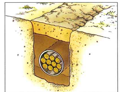
ケーブル埋設・埋戻し
