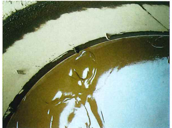
⑧ 製造中の流動化処理土
