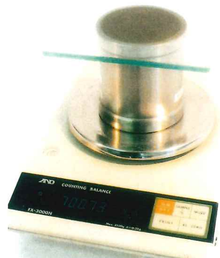
④処理土の密度の測定
