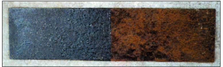
▲ 塗布30分後 (キレート反応により黒紫に変化します。)
