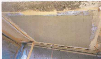
振動試験体（振動負荷終了時）
